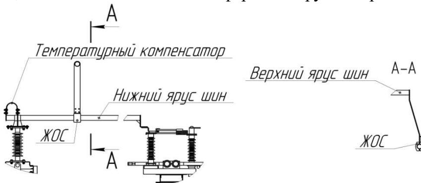
*Варианты крепления жестких шин 35 кВ на опорные изоляторы и на колонках разъединителей.*
